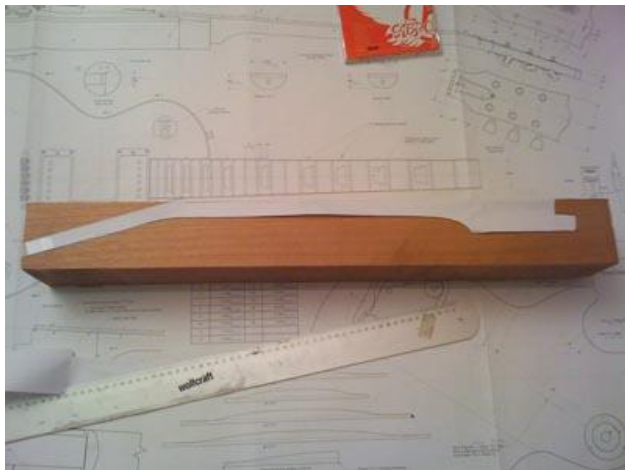
Die Maße des Halses per Schablone auf das Holz übertragen
