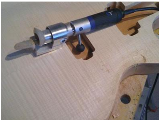
Hier fräse ich den Bindingkanal
