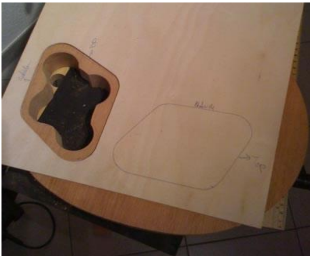
Diese dann mit Schraubzwingen in Situ festgemacht und ca. 2mm tief gefräst.
