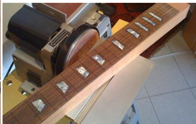
ausgeschnitten und mit braun gefärbtem Epoxydharz in die zuvor ausgenommenen Stellen eingeklebt
