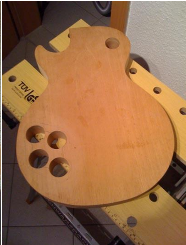
Diese Bohrungen wurden mit der Ständerbohrmaschine gemacht .
