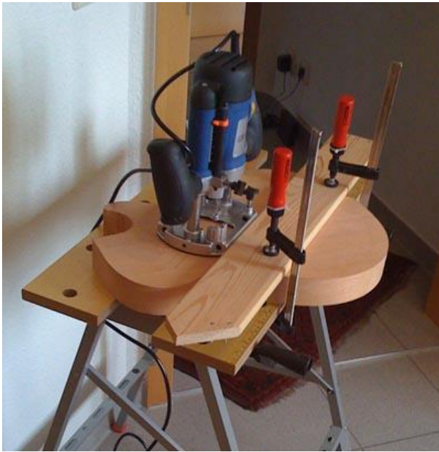
Die Fräsung für die Kabel vom Toggle-Switch zum E-Fach
