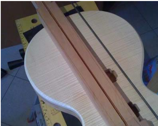
Die konkave Fräsung für den Trussrod
