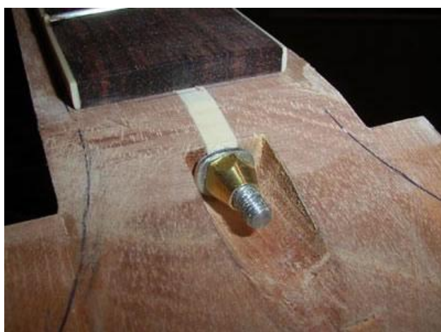
Trussrod mit Ahornabdeckstreifen
