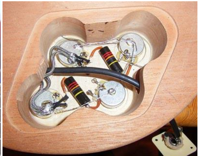
Die Potis eingesetzt und verkabelt
