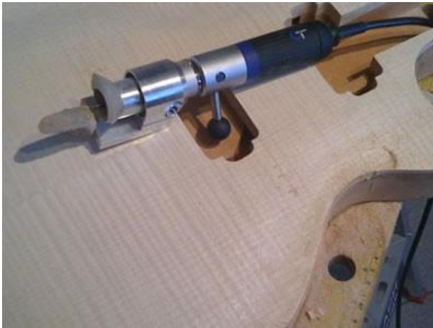
Hier fräse ich den Bindingkanal
