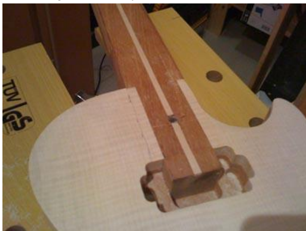
Der fast fertige Hals/Korpus-Übergang
