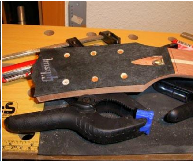
und das aufgeleimte Headstockveneer
