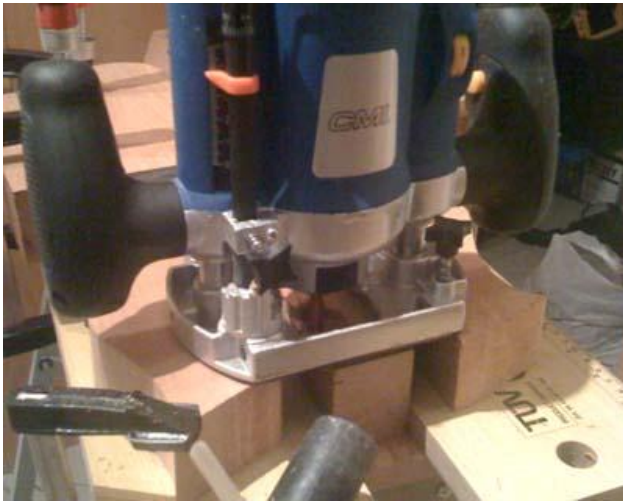
Am Hals den Tenon gefräst
