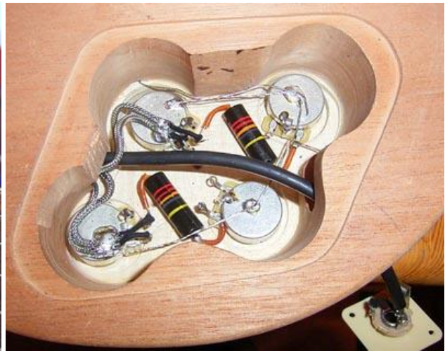
Die Potis eingesetzt und verkabelt
