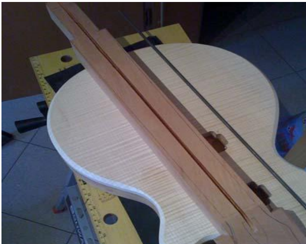
Die konkave Fräsung für den Trussrod
