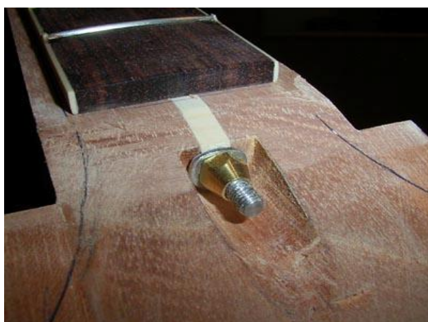
Trussrod mit Ahornabdeckstreifen
