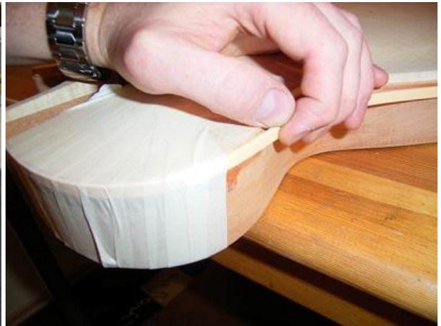
und klebe das Binding mit Aceton ein
