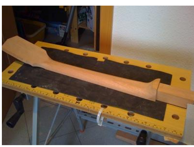
Der grob in Form geschliffene Hals
