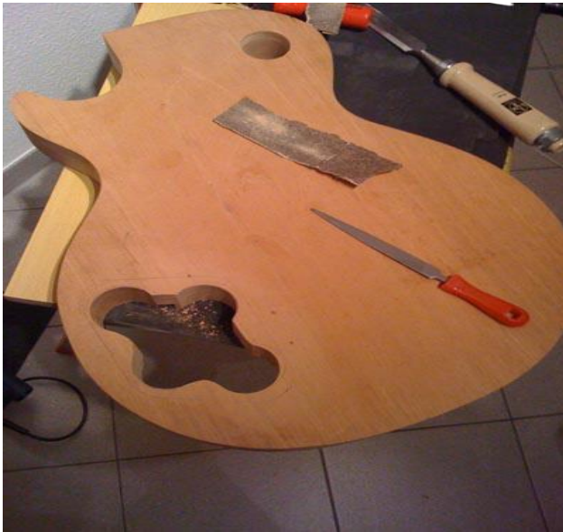
Den Rest mit der Stichsäge herausgesägt und verschliffen.
