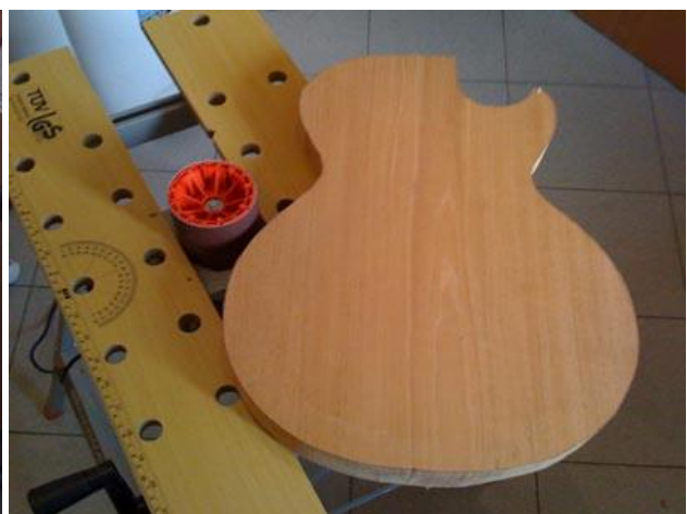
dann mit der Stichsäge ausgesägt und der Schleifwalze geglättet. Den Rest in mühevoller Handarbeit verschliffen.
