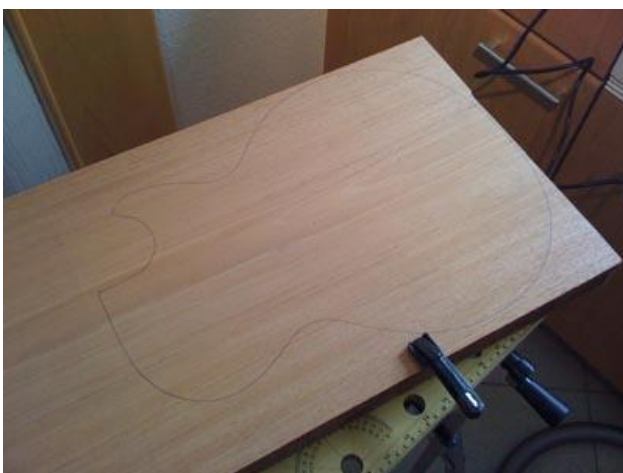
Zuerst die Kontur vom Plan auf das Holz übertragen
